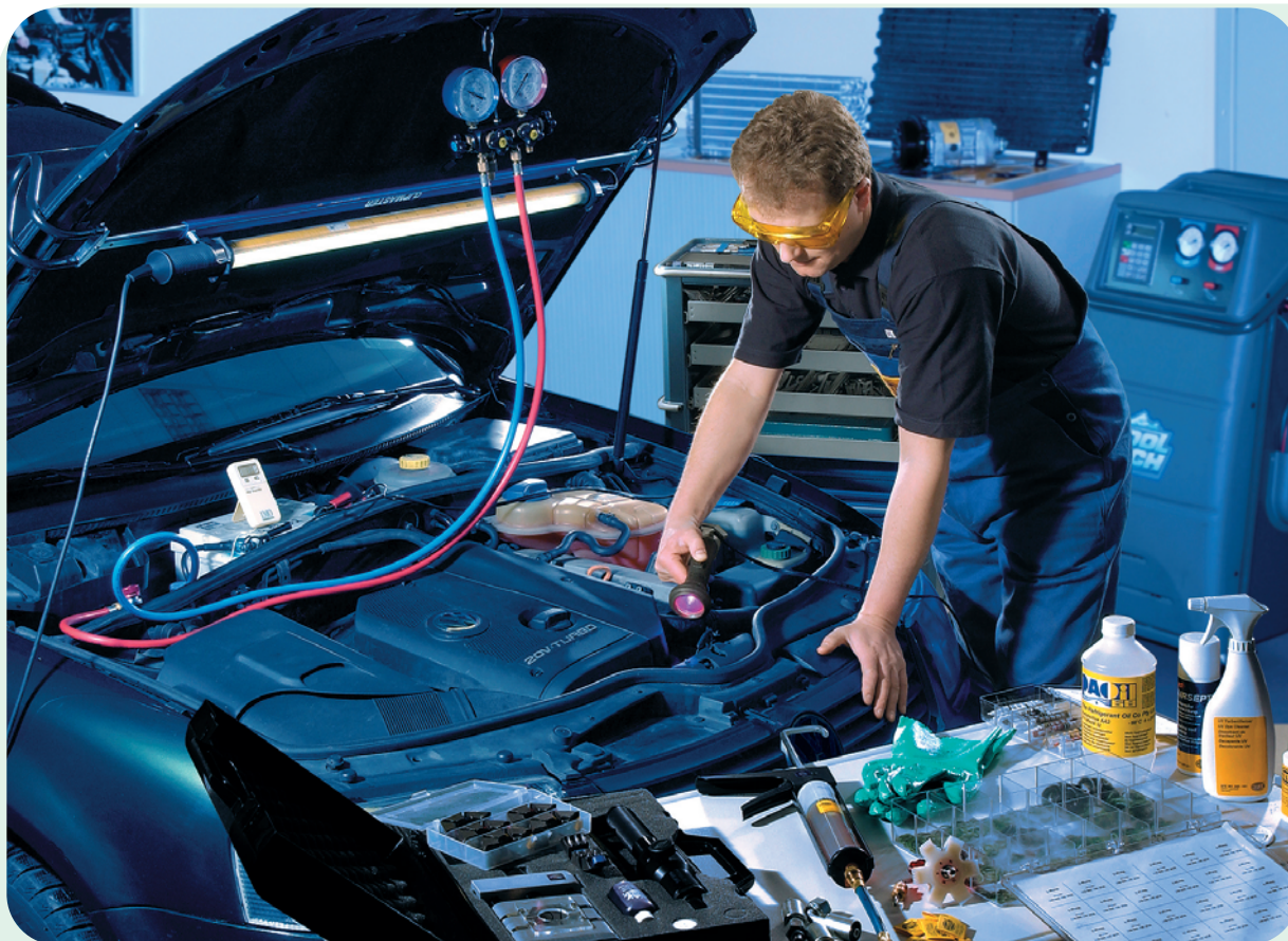
▲ Pour diagnostiquer une fuite dans un circuit de climatisation, il faut passer l'ensemble à la lampe infrarouge.
